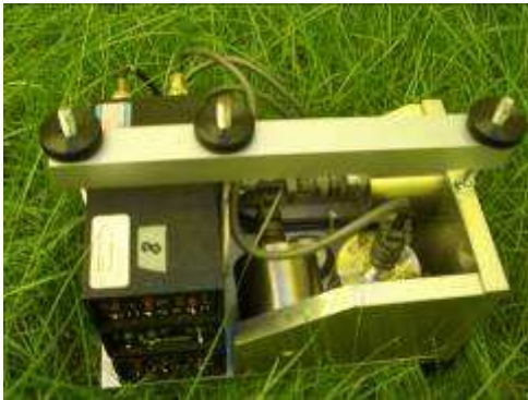
Abbildung 2: Wilcoxon-Schwingbeschleunigungsaufnehmer, 3 Aufnehmer zu einer triaxialen Einheit zusammengebaut
