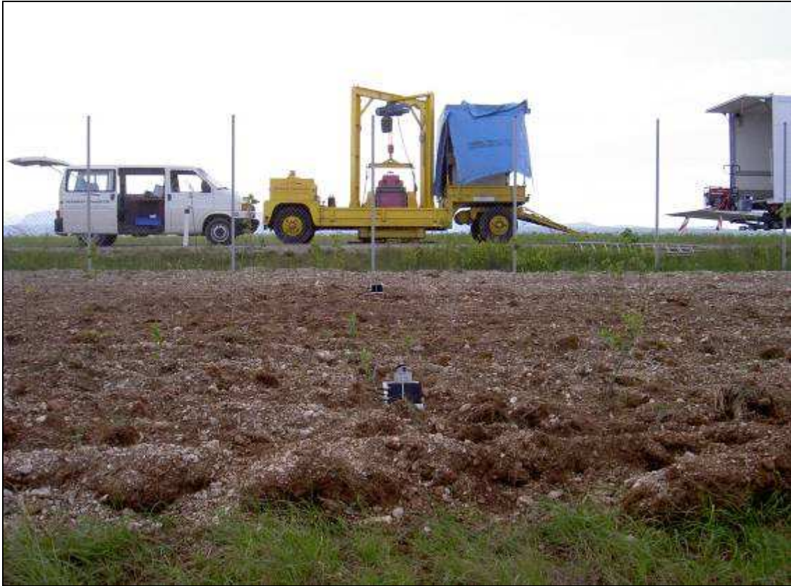
Abbildung 4: Messwagen (links), Hydraulischer Reaktionsmassenerreger VICTORIA (Mitte), 2 Schwingbeschleunigungsaufnehmer (Bildmitte und Vordergrund)
