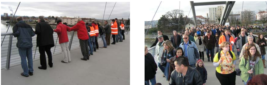
Abbildung 8: Mutwilliges Anregen weniger Personen, Fußgängertests mit Beteiligung von mehr als 800 Testpersonen
