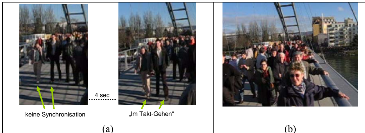
Abbildung 9: (aus Filmsequenzen entnommen) (a) Synchronisation der Fußgänger beim Aufschaukeln der Brücke und (b) Verhalten der älteren Versuchsteilnehmer
